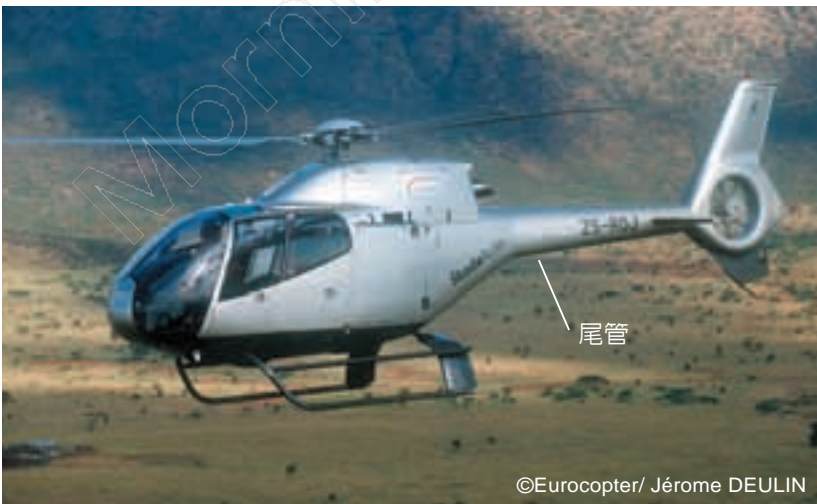
↑ 從側邊來看直升機的話，會發現約有一半的機體是為了裝設尾旋翼（後方旋翼）所需的尾管。
