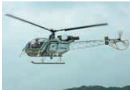
→ 最先搭載渦輪軸引擎的直升機，是南方飛機公司的「SE3130 Alouette」。照片為其後續機種「SA315B Lama」。
